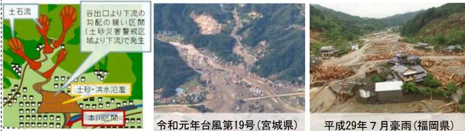
土砂・洪水氾濫イメージ 土砂・洪水氾濫による被害 土砂・洪水氾濫と同時に発生する流木による被害
