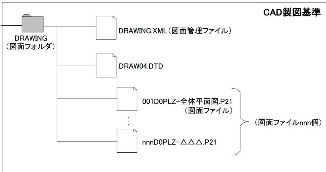
図 1-8 「DRAWING」フォルダに格納する図面ファイル（土木設計業務）
