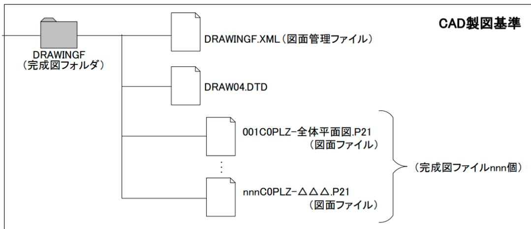
図 1-9 「DRAWINGF」フォルダに格納する図面ファイル（工事完成図書の納品）
