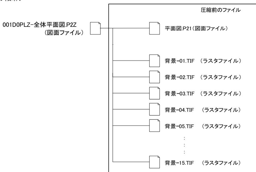
解説図 1-7 SXF(P2Z)形式のデータ構成例
