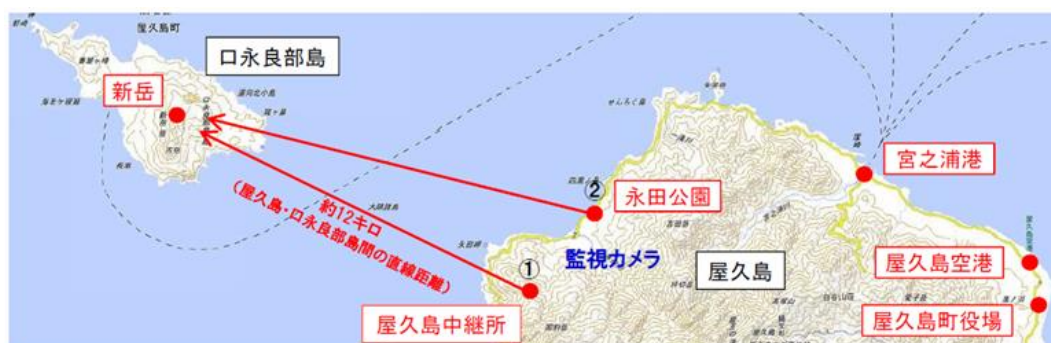
図 6.11 2015（平成27）年口永良部島噴火における衛星通信車の配置列
