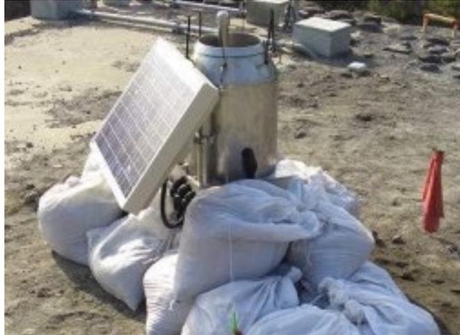
図 6.10 自動降灰量計の例（平成19年3月桜島にて撮影）
