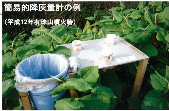
図 6.11 簡易降灰量計の例
