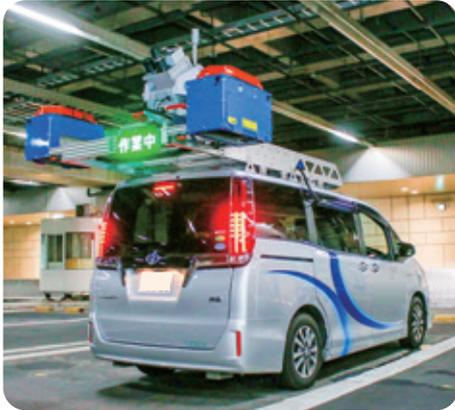
路面性状自動測定車により路面性状(路面のひび割れ、わだち掘れ、平坦性)を測定し、補修箇所・工法の選定の基礎資料とするため実施しています。島しょを除く都道及び指定区間外国道を対象に実施し、3年サイクルで調査を実施し、結果をデータベース化しています。
