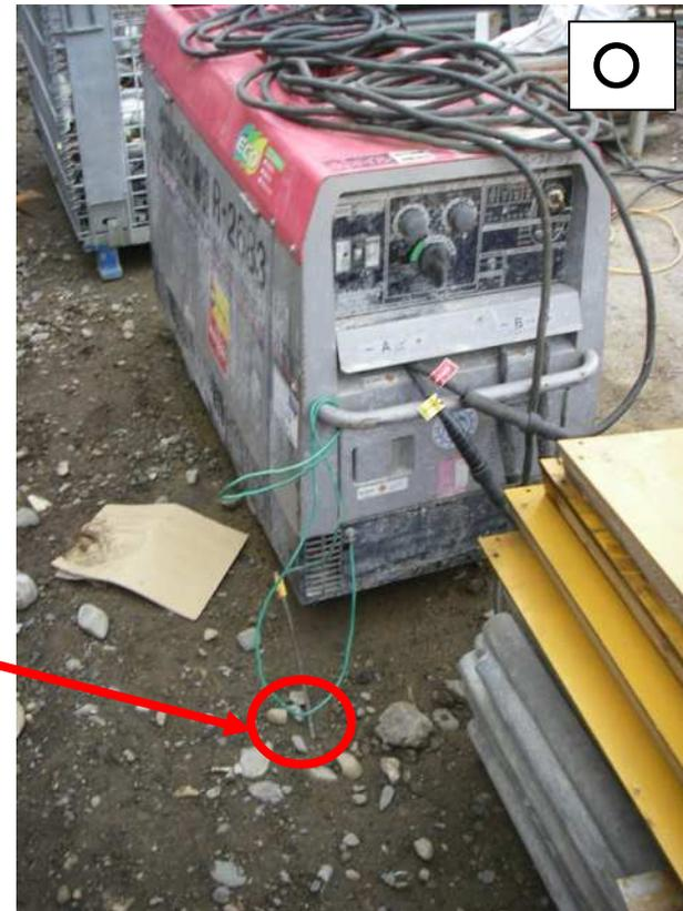
発電機の接地極が地中に差し込まれており、有効な接地抵抗値が確保されている。(労働安全衛生規則第333条 2の3号)
