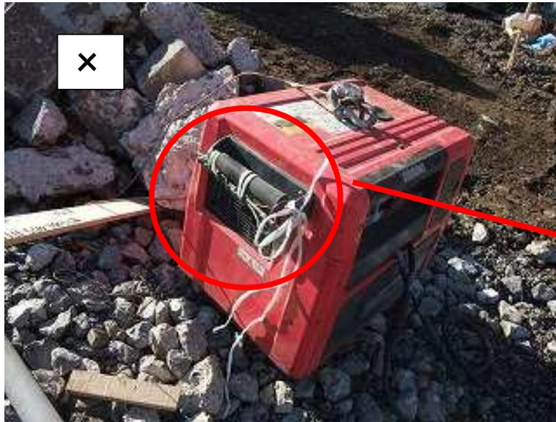
発電機の接地極が地中に差し込まれていないため、有効な接地抵抗値が確保されない。
