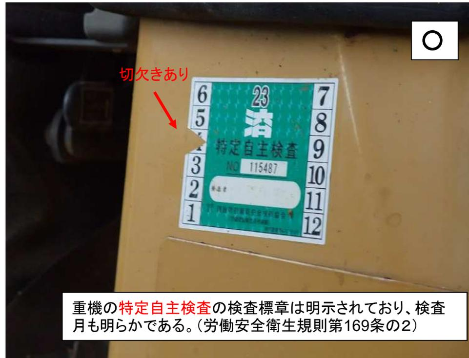
重機の**特定自主検査**の検査標章は明示されており、検査月も明らかである。(労働安全衛生規則第169条の2)
