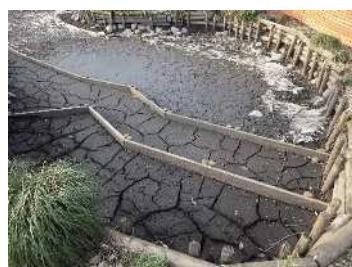
写真 12 天日干しによるひび割れ
