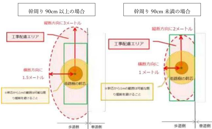
図3 工事配慮エリアの考え方
