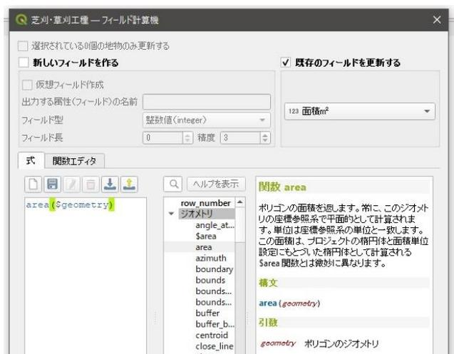
図 17 フィールド計算機と計算式の入力
