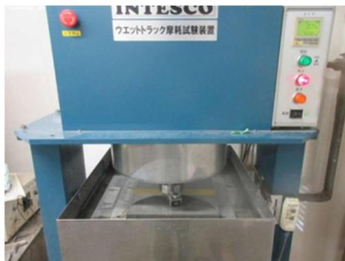
図—2 ウェットトラック摩耗試験機
