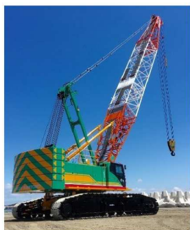
120tクローラークレーン
