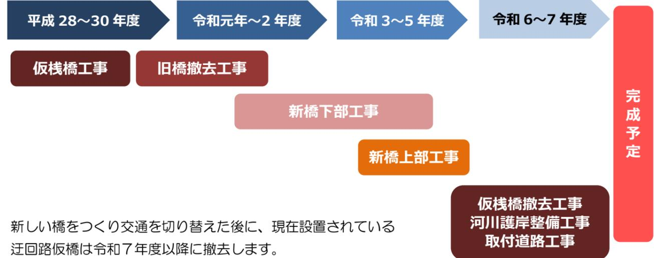
新しい橋をつくり交通を切り替えた後に、現在設置されている迂回路仮橋は令和7年度以降に撤去します。
