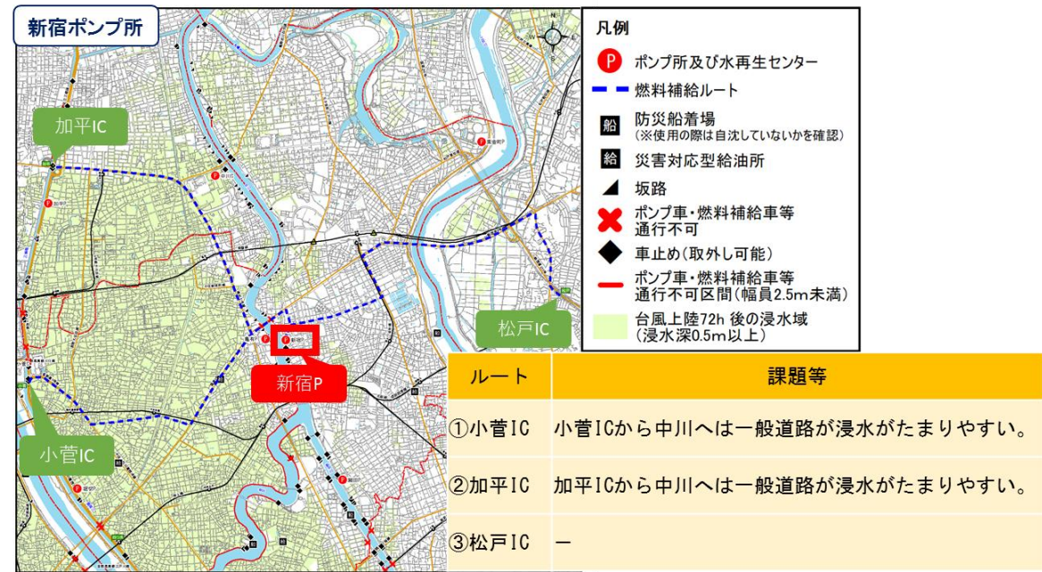
図 3-5 燃料補給ルート拡大図（例：江戸川区エリア 新宿ポンプ所）
