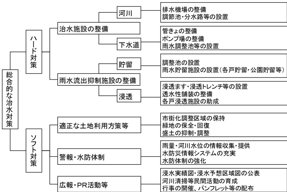
図 6-1 総合的な治水対策の概念図
