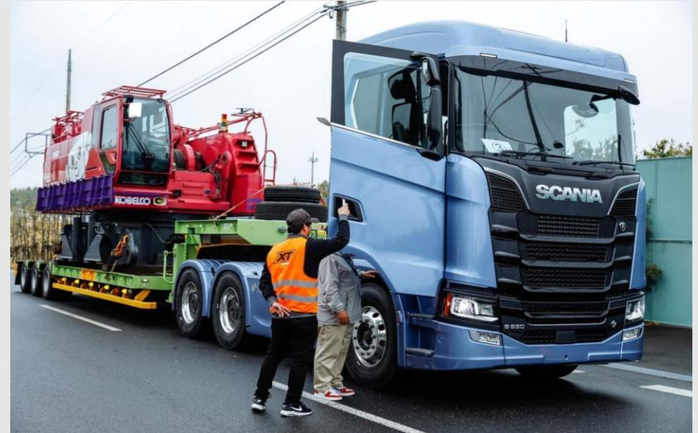
※20tの場合（寸法）全幅2.9m 全長15.5m車両総重量27 t
