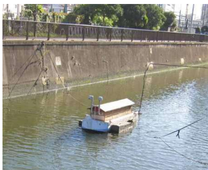
スカム発生抑制装置(馬引橋付近)
