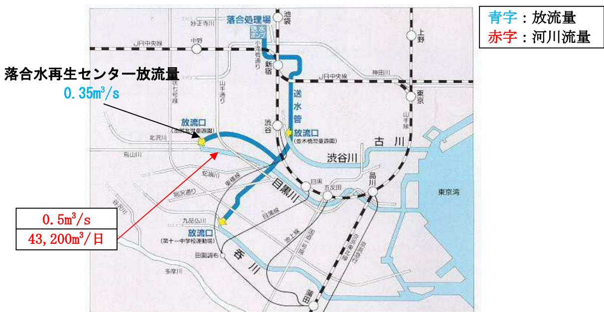
図 2-6 落合水再生センターからの再生水送水ルート
