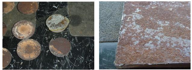
写真-11 尾久橋の鋼板の錆の状態
