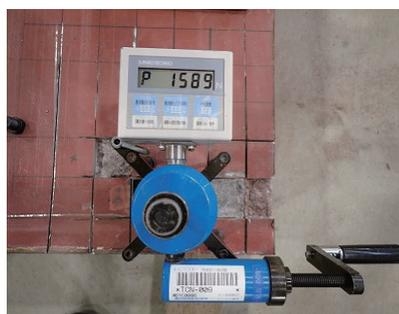
写真-10 健研式接着強度試験
