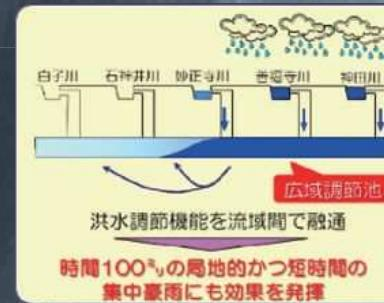
環状七号線地下広域調節池など8施設(総貯留量約110万m<sup>3</sup>)の整備を推進しています。
