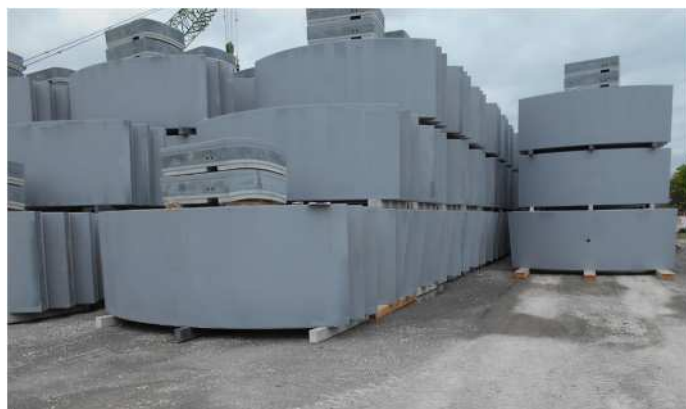
製作工場でのセグメントストック状況
