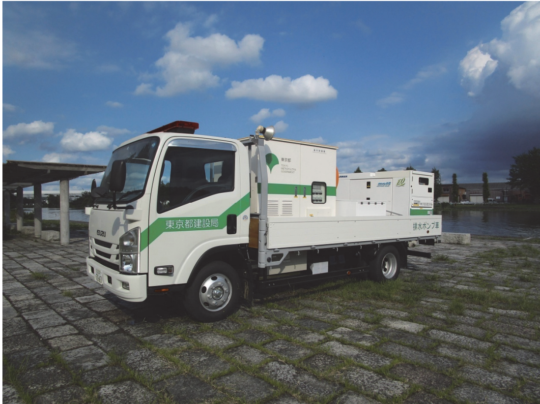
移動式排水ポンプ車
