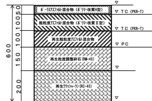
車道 アスファルトコンクリート舗装
