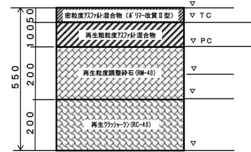
車道 アスファルトコンクリート舗装
