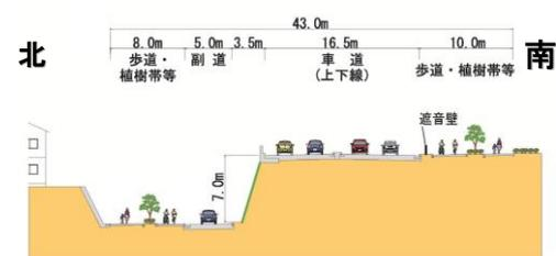
図-5 鶴牧区間採用案 横断面図
