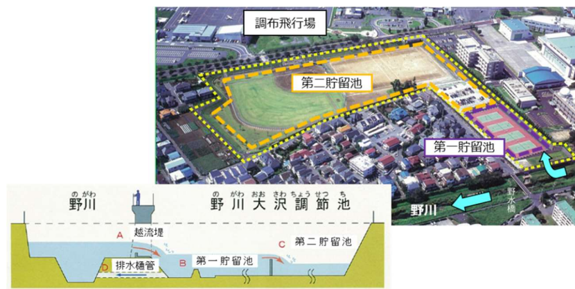
野川大沢調節池の全景としくみ
