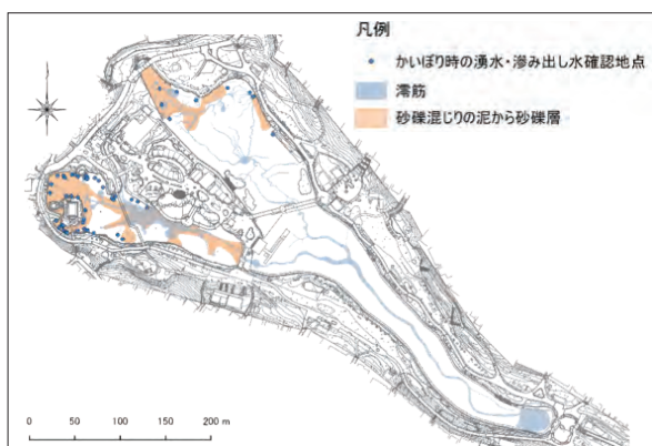
図3 井の頭池の底質と湧水の位置
