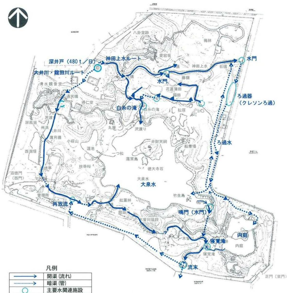
図3-14 小石川後樂園の池水の流路系統
