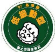
低騒音型、低振動型建設機械の標識ラベル
