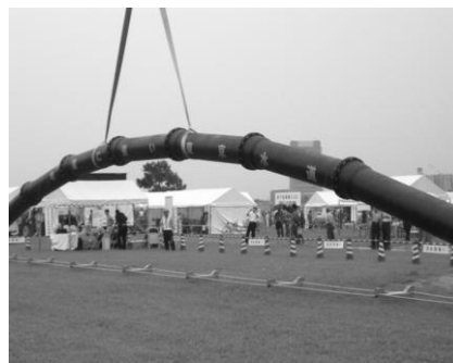
耐震継手管のデモンストレーション (クレーンによる吊り下げ)
