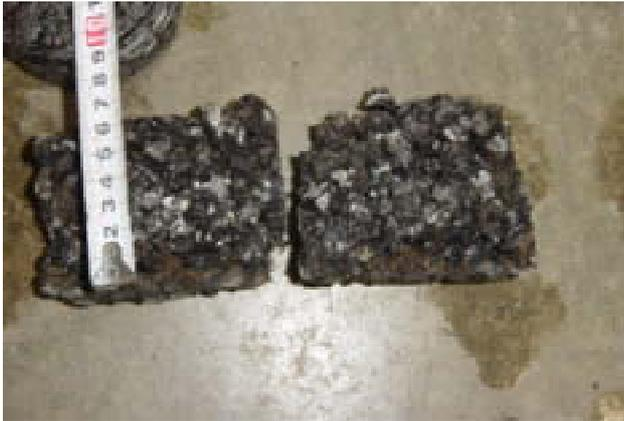
写真 - 1 既設低騒音舗装の空隙詰まり状況
