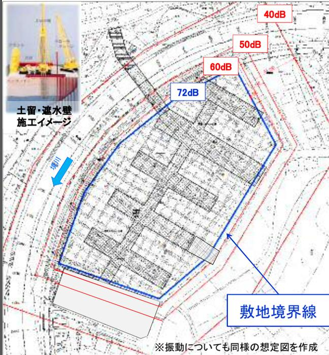
土留・遮水壁施工時の想定騒音図(防音パネル設置時)
