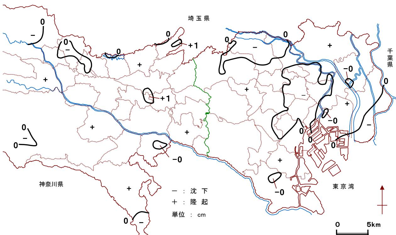
図-2 平成26年の地盤変動量図
