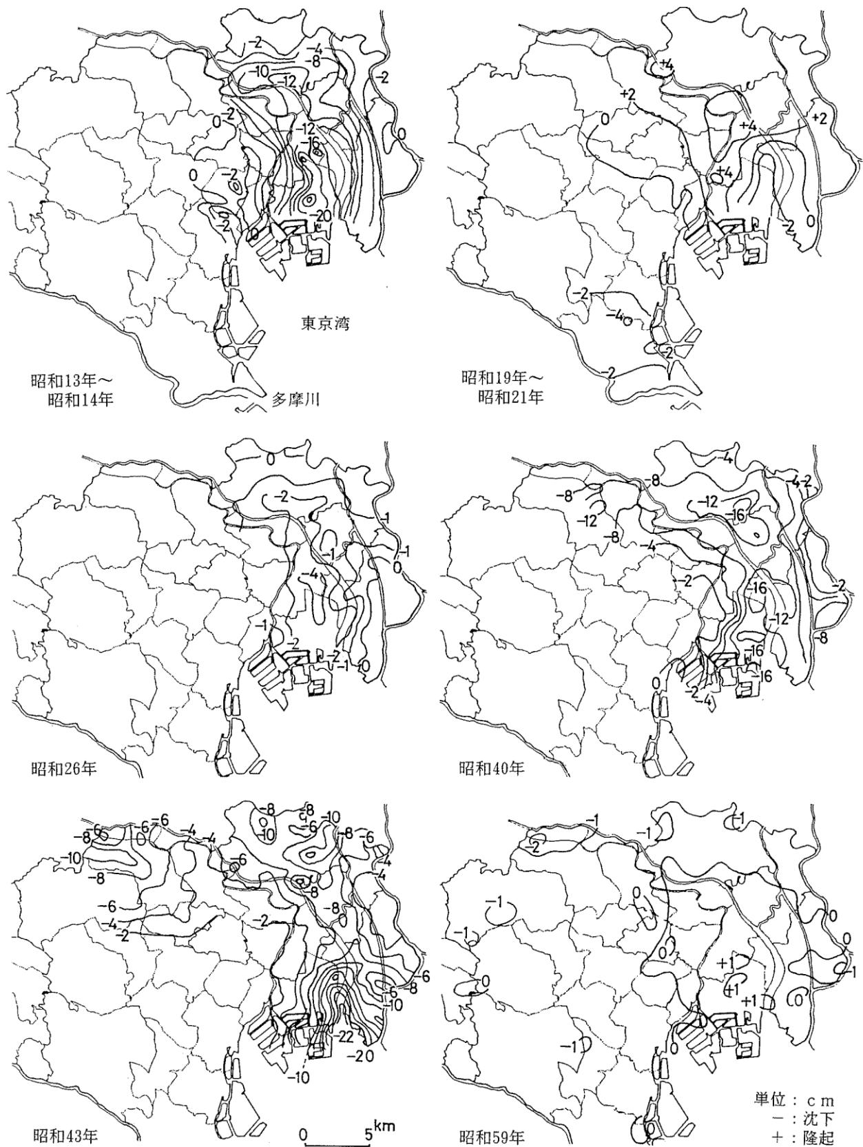
図-14 区部の地盤変動状況の変遷
