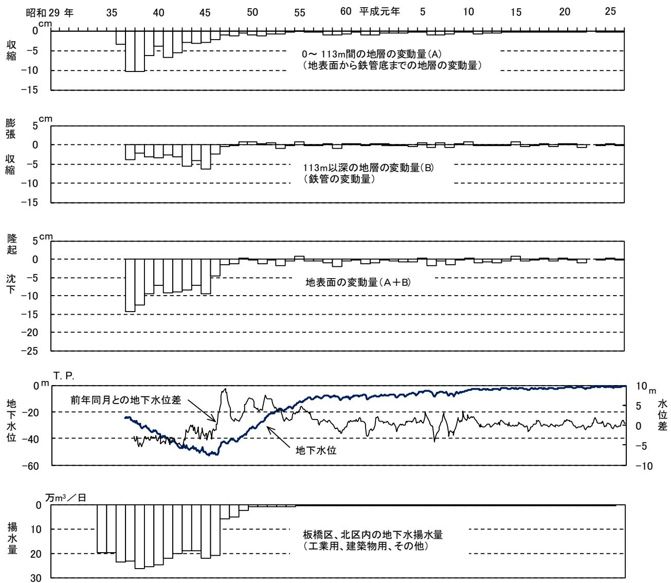
図-16 戸田橋第2観測井(113m井)における地盤変動量と地下水位との関係
