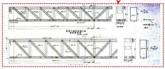
図-6 鉄筋コンクリートトラス部材の詳細図
