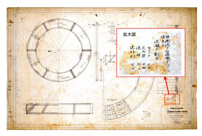
コンクリート 図-1 新大橋図面 (混凝土の割合) (1911年)
