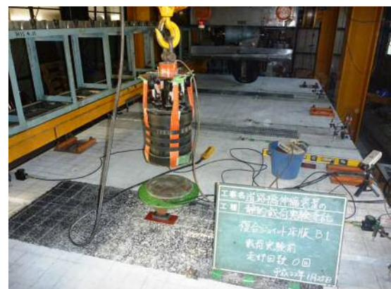
写真-5 重錘落下たわみ測定状況
