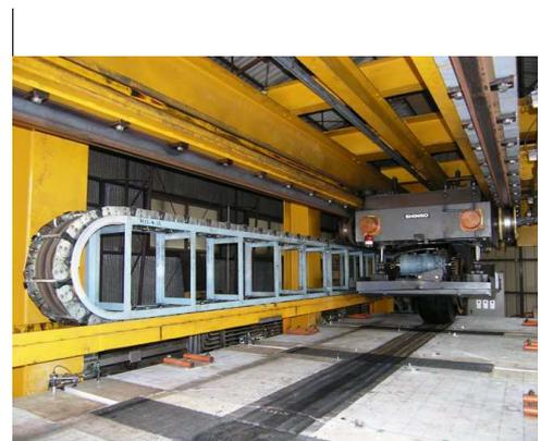
写真-1 輪荷重走行試験状況
