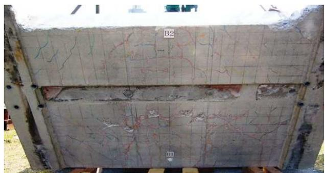
写真 - 2 床版 B1 押し抜きせん断破壊
