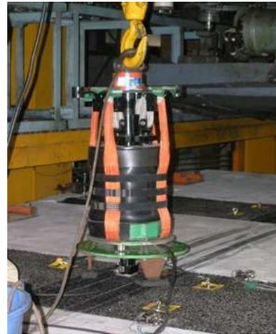
写真 - 5 重錘落下たわみ測定状況
