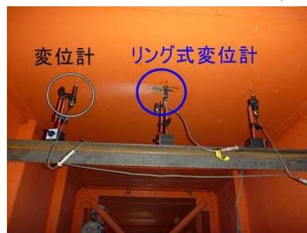
写真 - 4 方法 2 および方法 3 の床版下面変位計
