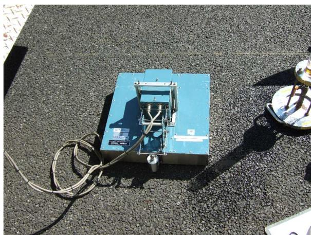
写真 - 3 回転式すべり抵抗測定器
