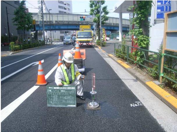
写真 - 6 現場透水試験器
