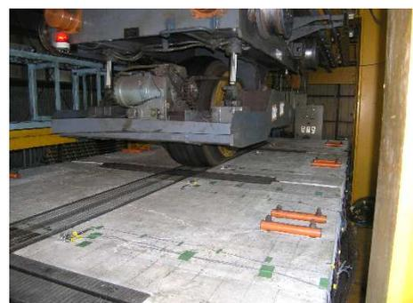
写真 - 1 輪荷重走行試験状況
