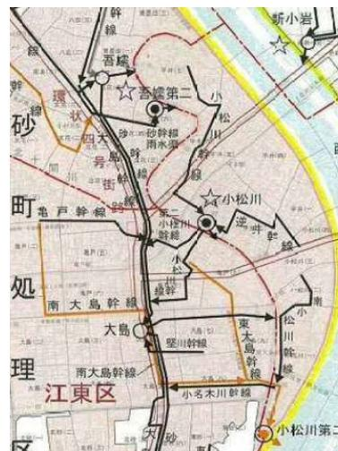
◇雨水放流については、時間雨量50mmの場合に街中に浸水がおきないための対策をしているということであり、雨水放流はそれ以前から始まっています。今後小松川第二ポンプ所が整備されれば、荒川へ直排化され、旧中川への雨水放流もなくなります。
