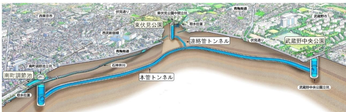
図 4-5 石神井川上流地下調節池のイメージ
