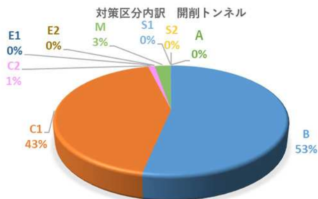
図-14 令和4・5年度定期点検結果-判定区分-(開削トンネル)
