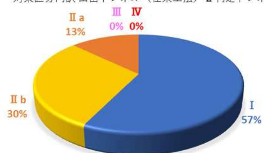
対策区分内訳 山岳トンネル（在来工法）Ⅱ判定トンネル
