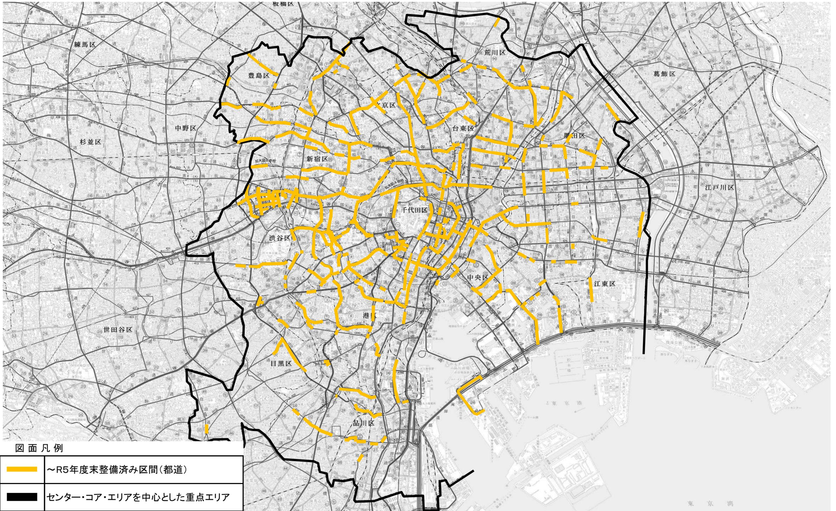
※この図面は、遮熱性舗装及び保水性舗装を含む路面補修工事の工事箇所を示したものであり、
