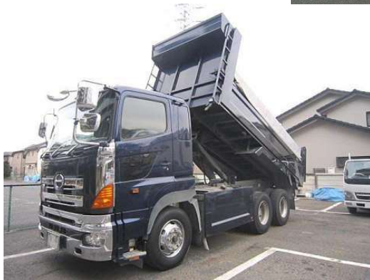
ダンプトラック（2 t～10 t） 材料の搬（出）入と産業廃棄物の搬出に 使用します。 工事現場内での土の運搬にも使用します。
