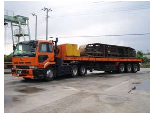
トレーラー（13 t～20 t積） 大型重機等の回送時に使用します。
