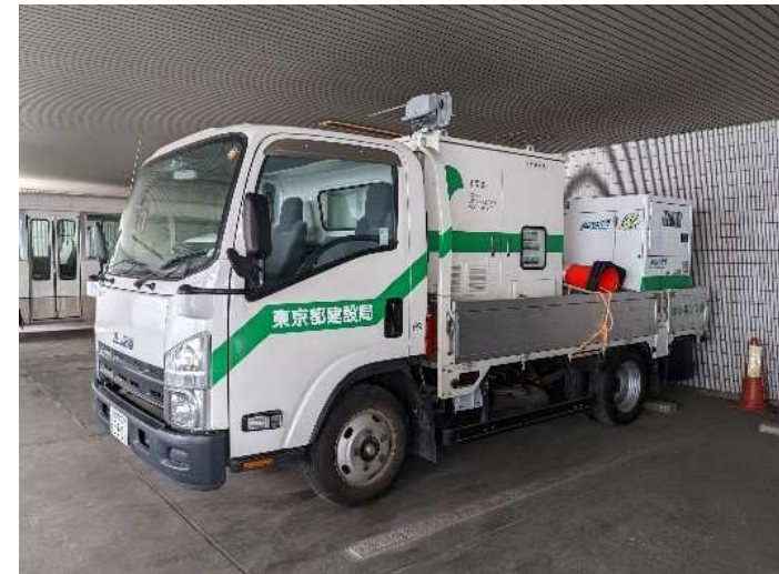
＜都所有の排水ポンプ車＞
