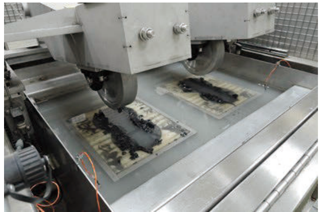
写真 2-2 HWT 試験機の状況
