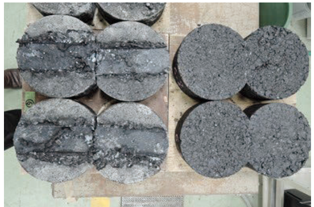
写真 2-3 試験後と未試験の供試体
