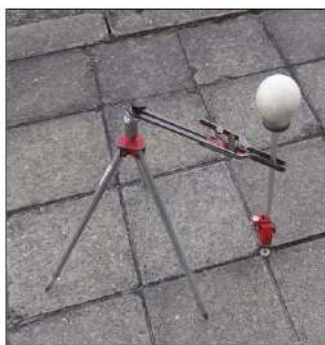
写真一3 3Dデータ取得のための機材
