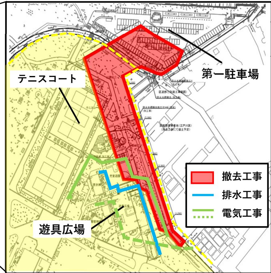
\* **■** の範囲では撤去工事，**—** ではそれぞれ排水管工事，電気の配管・配線工事を行います。（**⋯** は通信線工事）
