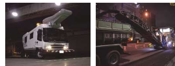
路面性状自動測定装置（車両）
