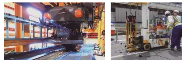
輪荷重走行試験機による促進疲労試験
