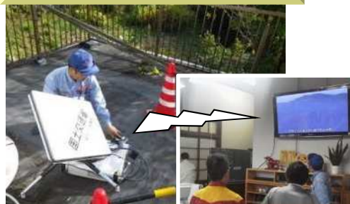
【H26.9 御嶽山の噴火】(長野県王滝村) ※Ku-SAT: 衛星小型画像伝送装置
