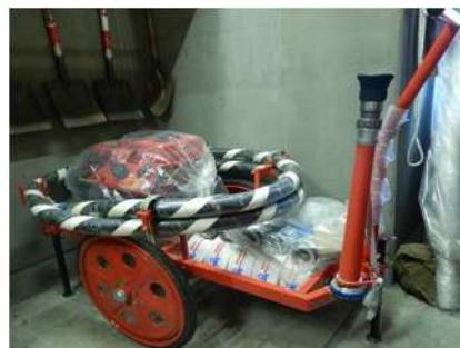
▲ 排水ポンプとして活用可能な可搬型消防ポンプを配備 (小金井市)
