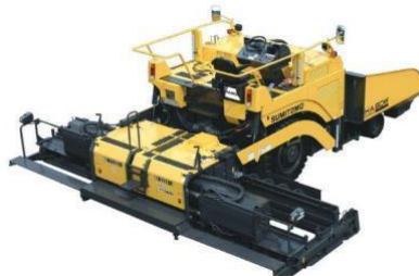
フィニッシャー (7.5t 舗装幅5m) 舗装をする際に使用します。
