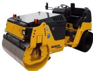
コンバインドローラー(3t) 敷均し材を固める際に使用します。
