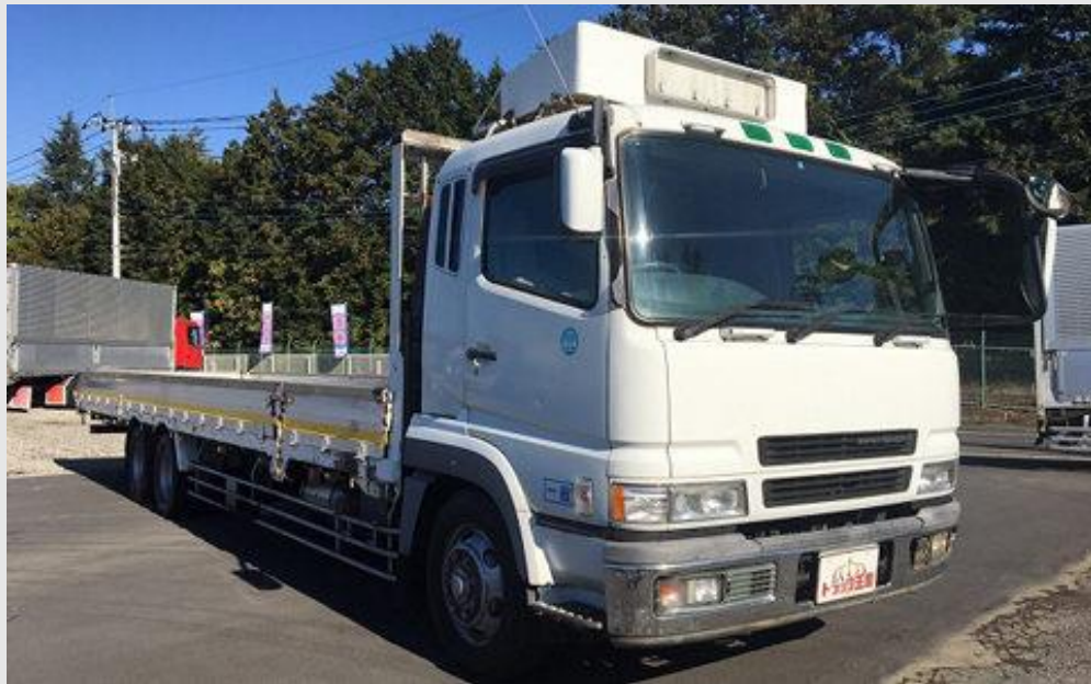
※4tの場合（寸法）全幅2.26m 全長8.2m
